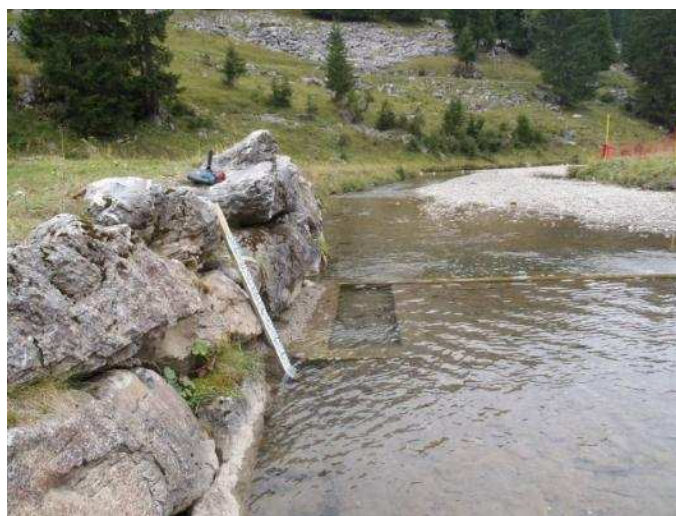
Echelle limnimétrique – photo Sage Environnement
