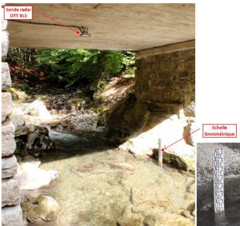
Implantation sonde radar et échelle limnimétrique
